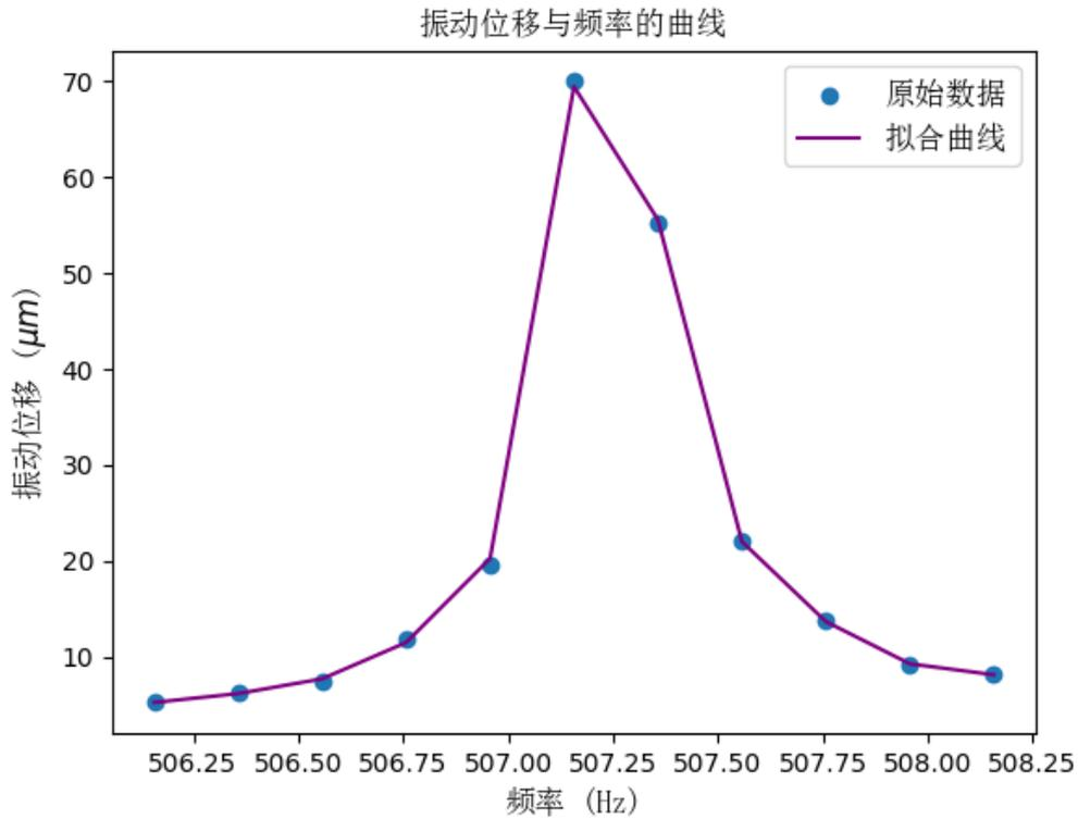
图 12: 振幅与频率的关系
